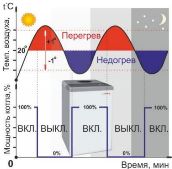
Обычно термостат управляет котлом в релейном режиме. Он при отклонении температуры от заданных значений, замыкает или размыкает контакты выходного реле, включая и выключая горелку.
